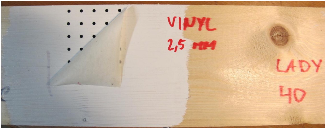
Figur 25 Applikeringspapiret trekkes av og prikkene sitter igjen på prøvestykket.
