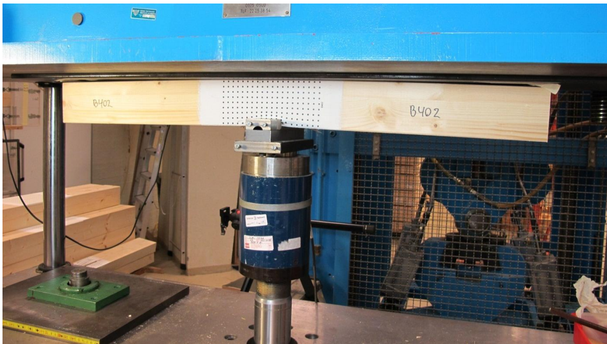
Figur 32 Svilletrykk av prøvestykke B402 i Dartec testmaskinen.
