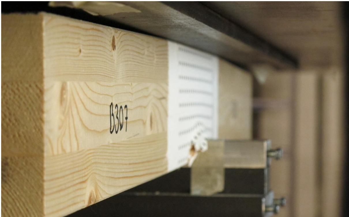
Figur 50 Prøvestykke B307 under testing, ved belastning beveger prøvestykkets ender seg opp fra underlaget.
