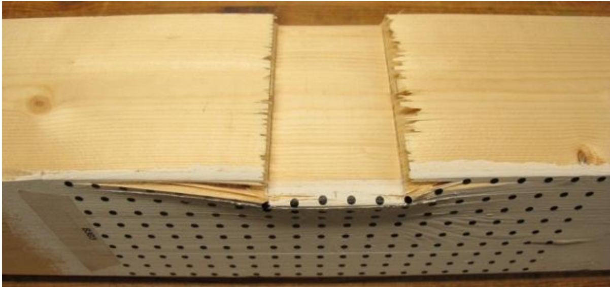
Figur 49 Prøvestykke B303, meget tydelig utbuling av trefibrene ved trykkplaten.
