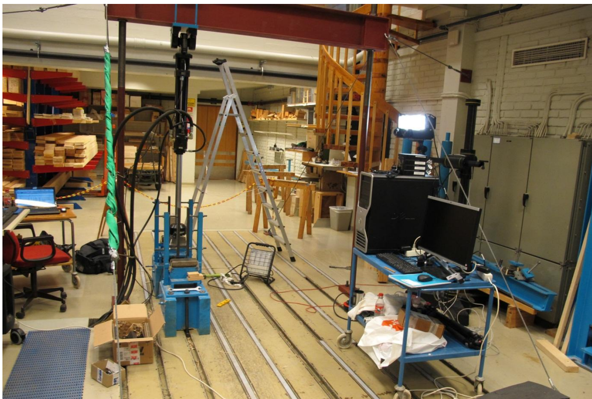
Figur 31 Oppsett for testing av bjelker, i dette tilfellet G3 - serien. Til høyre i bildet ser man datamaskinen som ble brukt ved fotogrammetrien og bak denne kan man skimte kamerastativet og kameraene samt en lyskilde.
