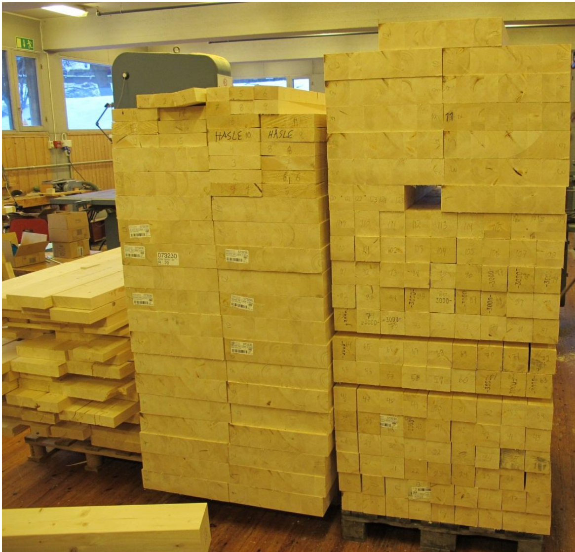
Figur 2 Prøvestykkene ferdig kappet og klare for grunning og påføring av prikker.
