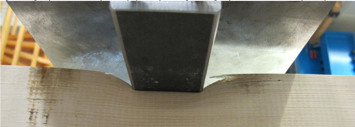
Figur 7 Hengekøyeeffekten under testing, tilfelle G3.
