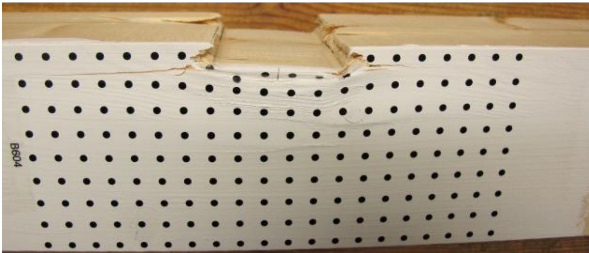
Figur 61 Prøvestykke B604, man ser tydelig hvordan trykkplaten roterer og går skjevt inn i trevirket.
