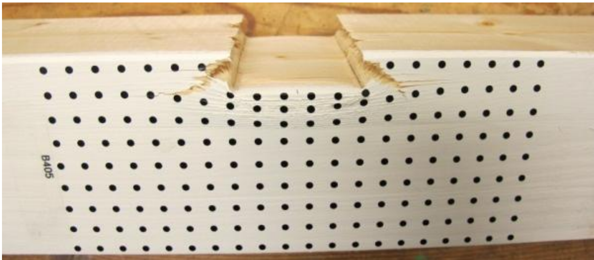
Figur 53 Prøvestykke B405, med en tydelig tendens for spredningsvinkelen.
