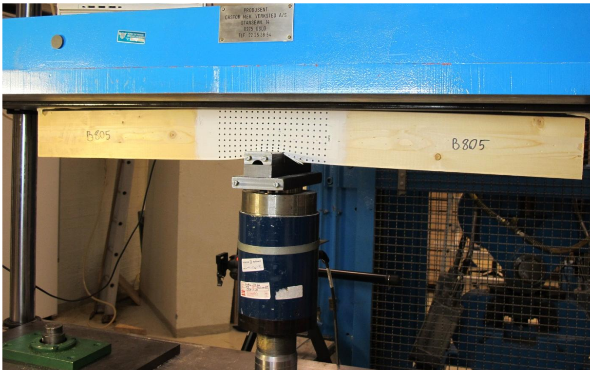
Figur 70 Prøvestykke B805 under testing, prøvestykket bøyes på grunn av lastpåføringen.
