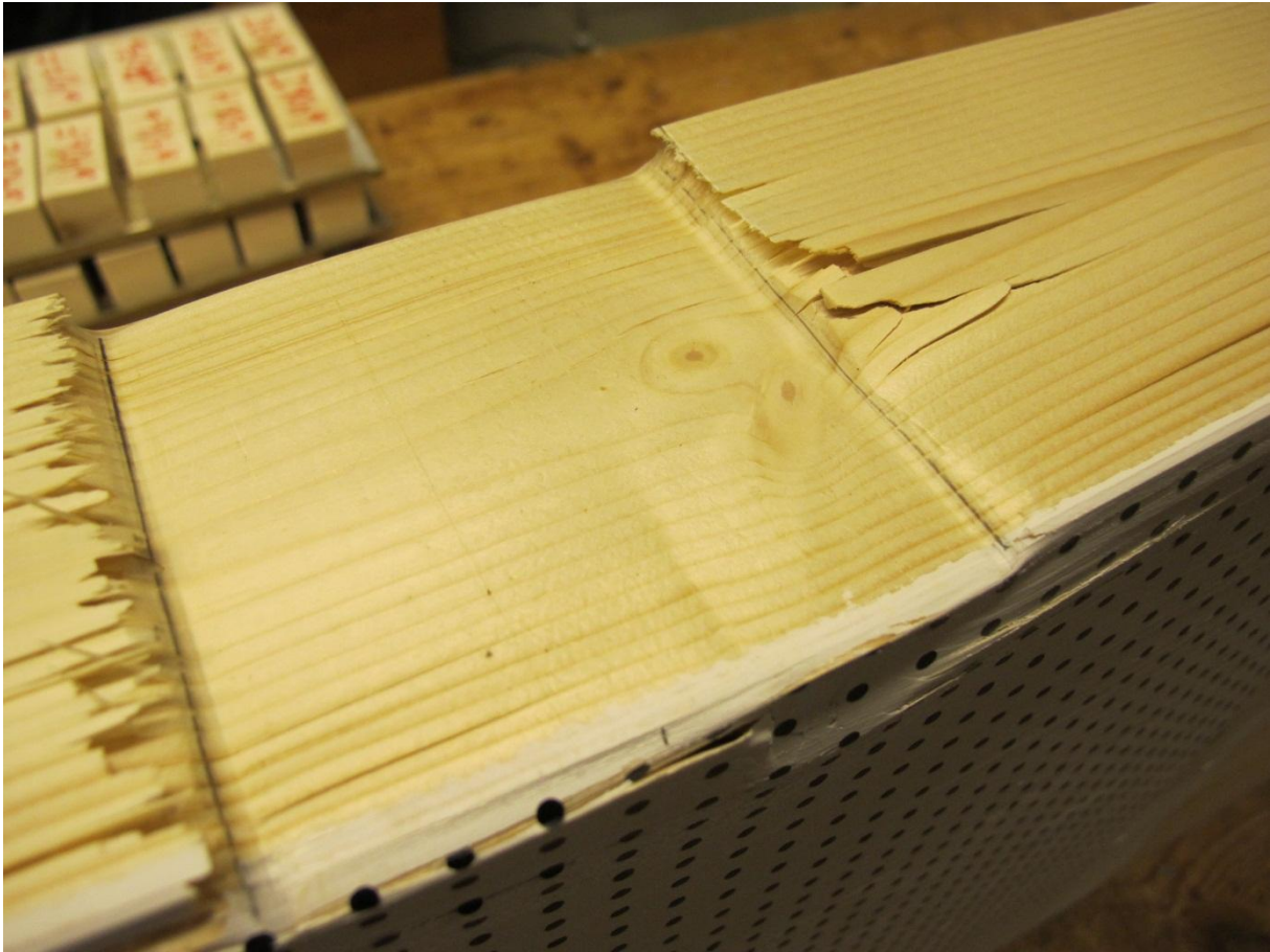
Figur 108 Prøvestykke G411, kvist under trykkplaten fører til forstyrrelser og oftest til høyere fasthet.
