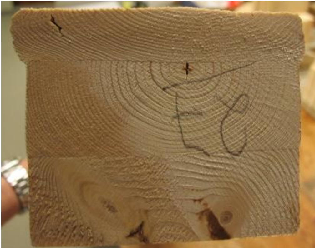
Figur 98 Prøvestykke F313, deformasjonen oppstår lokalt, liten påvirkning av lamellen i midten.
