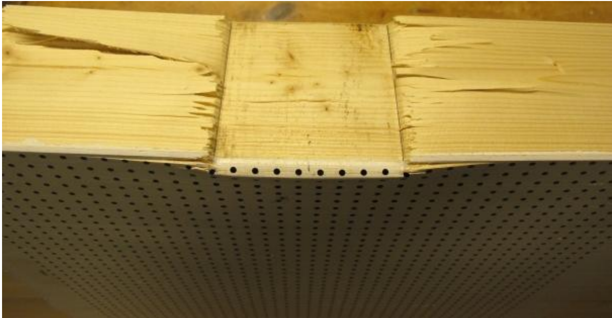
Figur 78 Prøvestykke B1001, kvist i området trykkplaten har virket fører ofte til splintring av trevirket.
