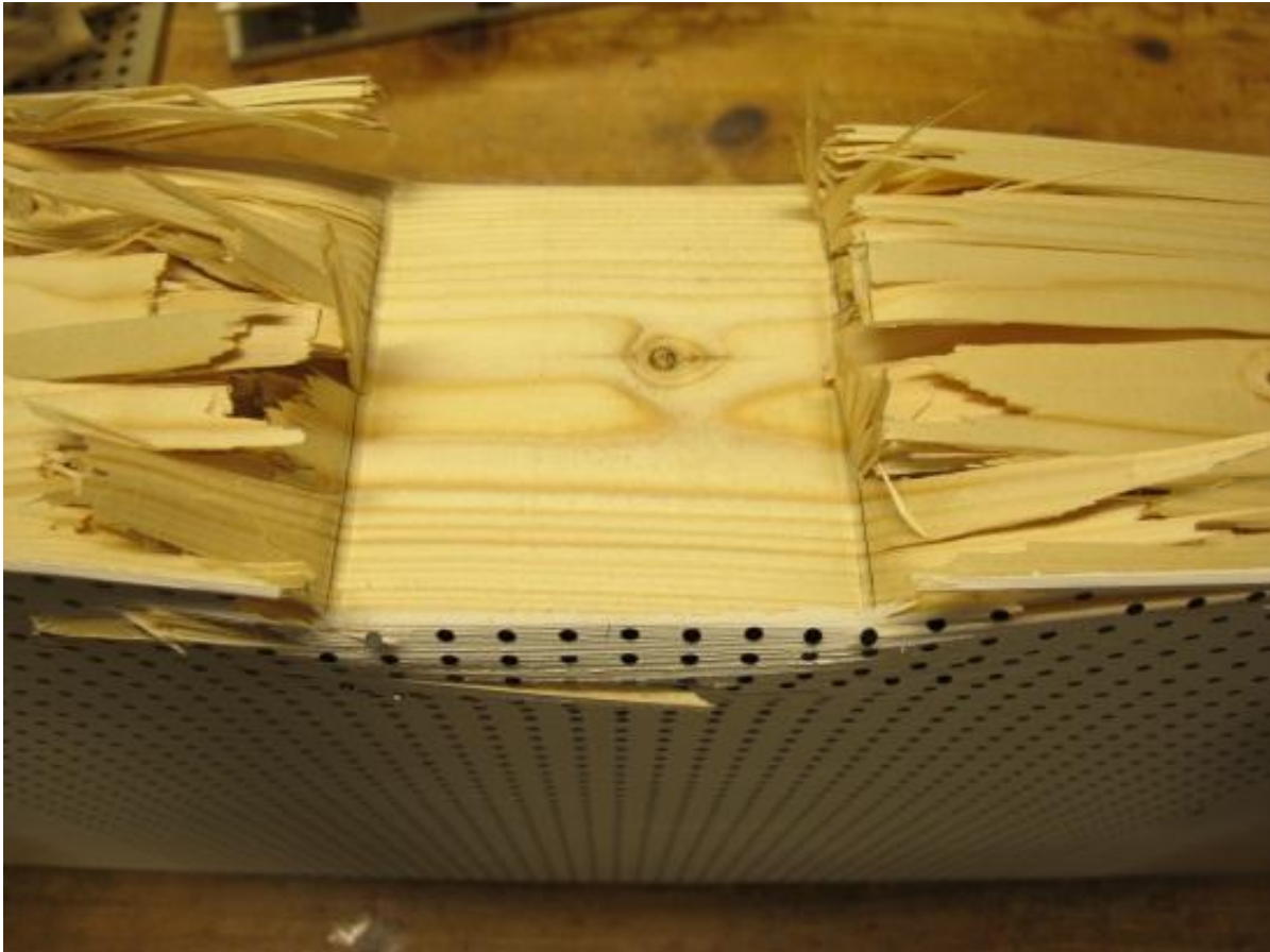
Figur 106 Prøvestykke G407 etter testing, mye splintring av trevirket i området rundt trykkplaten.
