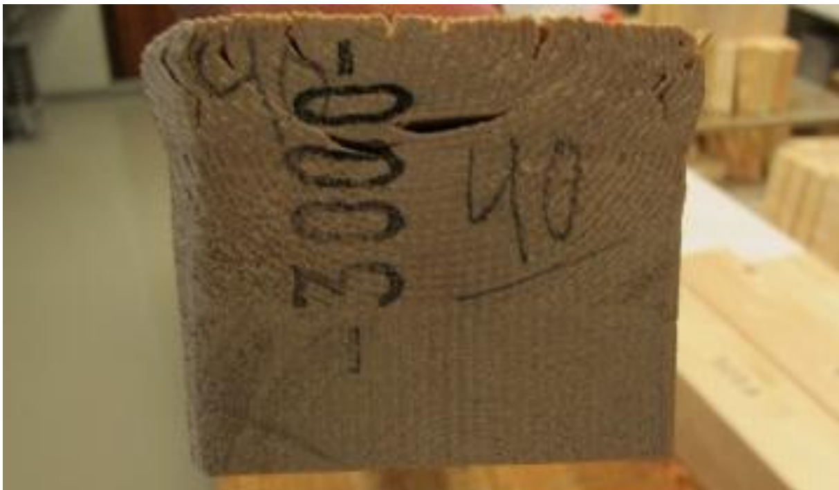
Figur 93 Prøvestykke F203 etter testing, tegn til kolvsprekk og mye oppsprekking, men lite innvirkning på lamellen i midten.
