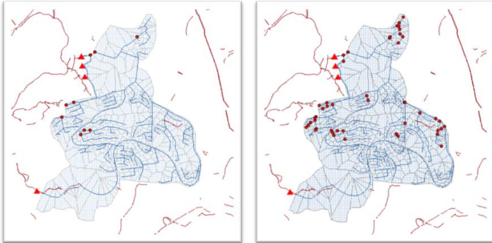
Figur 43: Simulering symmetrisk regnhyetogram med 100 års gjentaksintervall og 60 minutters varighet. Til venstre; dagens IVF-verdier, til høyre: Klimatillegg 50 %
