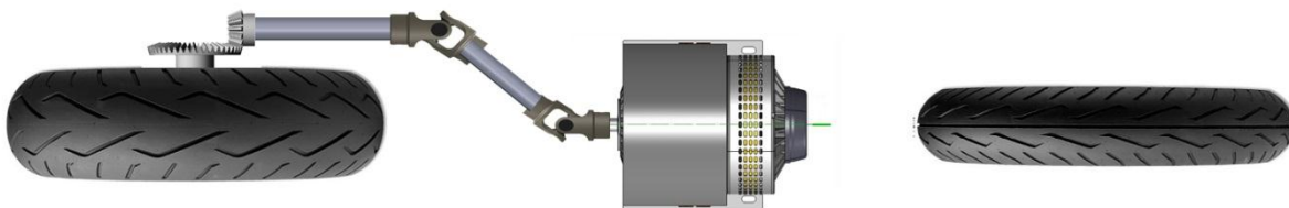
Figur 43: Oppsett med vinkeldrev og to universalledd. Kraften flyttes ut på siden ved å bruke universalledd og deretter bruke et vinkeldrev for å snu kraftretningen ut til drivhjulet.
