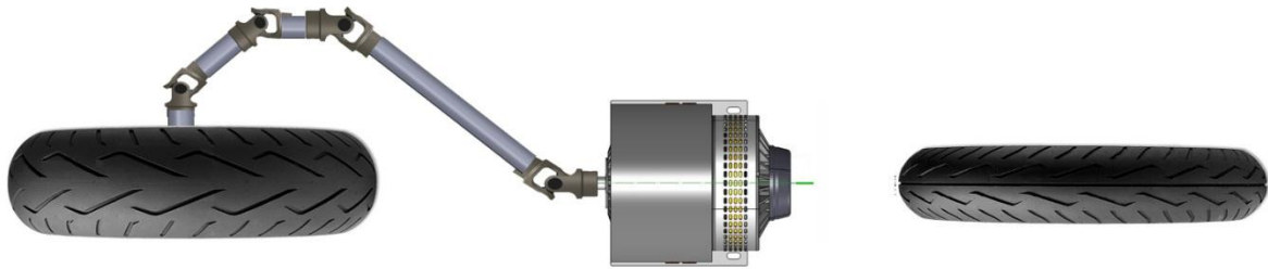
Figur 45: Oppsett med flere universalledd for å flytte kraften på siden av drivhjulet og snu den inn mot drivhjulet igjen.
