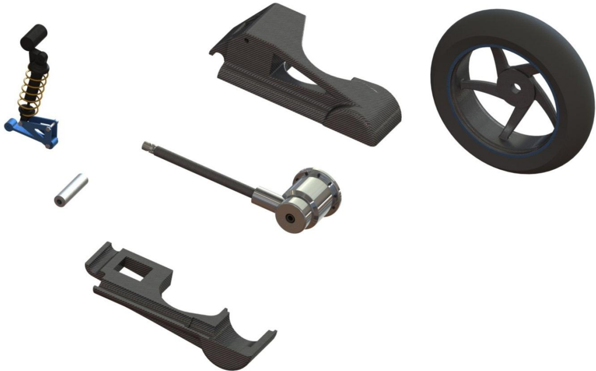
Figur 113: Plasseringen av girkasse nummer to inne i svingarmen. Denne girkassen vil bli støpt inn i svingarmen og kun baklokket og universalledet vil være synlig. [9] (Foto: Hans Ola Krog)
