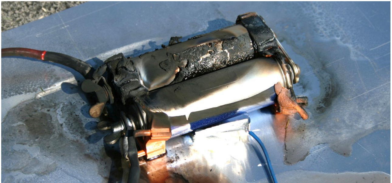
Figur 72: Battericellen etter ca. ti minutter. Battericellene er fullstendig utbrent og ødelagt. Høyeste temperatur i løpet av testen ble logget til ca. 160 grader celsius. (Foto: Lars J. Norberg)
