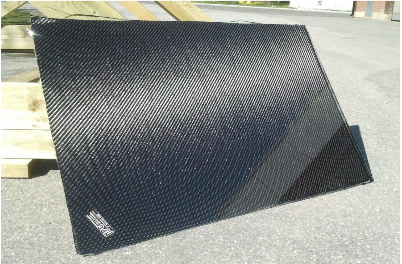
Figur 116: Karbonplaten leverer fra HPC i Fredrikstad. Denne platen er 4 mm i tykkelse og er stor nok til en av de to batterikassene som skal lages. (Foto: Lars J. Norberg)
