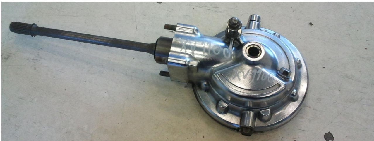
Figur 55: Bakre del av svingarmen på en Yamaha Virago 1100. Denne skal stripes ned til løse komponenter for å kunne gjennomføre hardhets testing av tannhjulene. (Foto: Lars J. Norberg)
