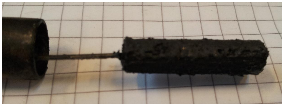
Figur 4-14: Kullrest etter forsøk 3, 8 mm. Størrelses- og formmessig ser kullresten omtrent ut som før pyrolysen.
