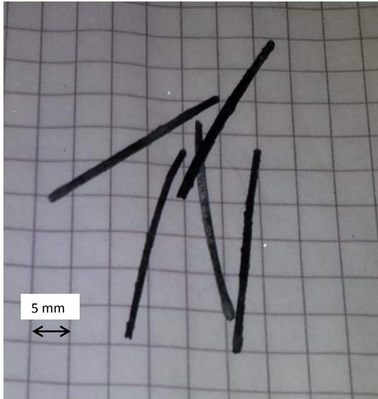
Figur 4-2: Kullrester fra fem forsøk med \varnothing=1 mm. Kullstavene er svært sprø og skjøre.
