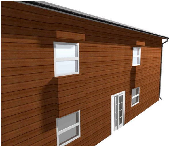
FIGUR 38: ILLUSTRASJON AV HVORDAN TILTAKET PASSIV SOLAVSKJERMING [LØVE, 2012]
