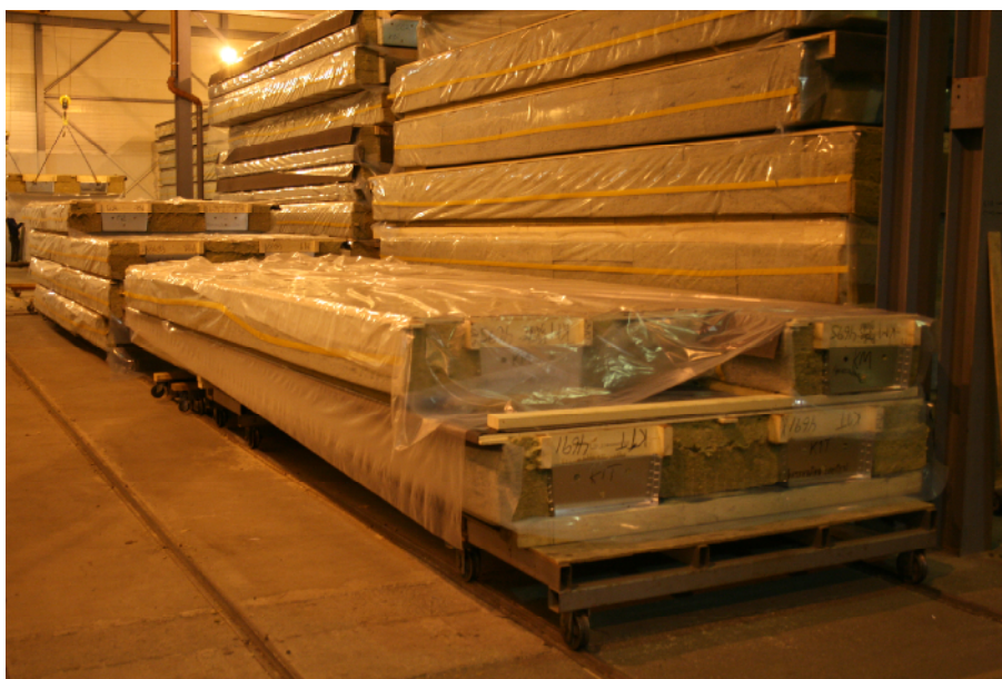
Figur 2.18 Bilder fra ekskursjon til fabrikk til Lett-Tak Systemer AS. Tilpasning av takelement (øverst) og lagring av ferdige takelement (nederst).
