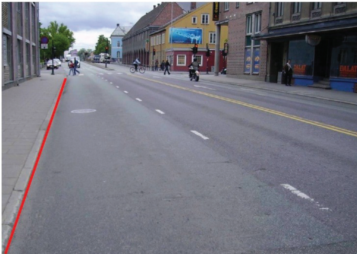
Illustrasjon 15: Fortauskant registreres som vist på bildet med rød strek. (Statens_kartverk 2011c)
