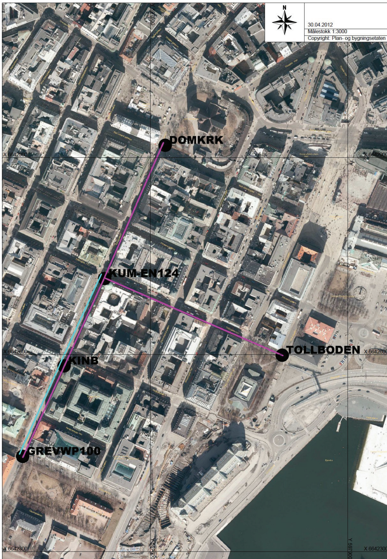
Illustrasjon 10: Lys blå linje viser strekning hvor målingene er blitt gjort og hvor laserskanningen har foregått og kontrollmålinger har blitt gjort. Lilla farge viser linjen mellom hovedpunktene som danner grunnlagsnettet.
