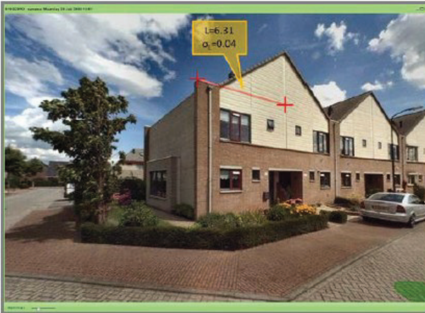
Illustrasjon 8: Eksempel på lengdemåling i et panoramabilde med dybdeinformasjon. Hentet fra (Beers et al. 2011)
