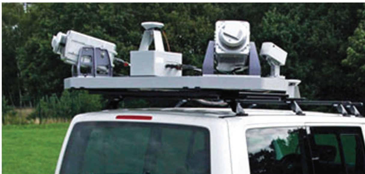
Illustrasjon 3: Bilde fra siden av hvordan laserne og GNSS antenne er montert. Bilde hentet fra (Graham 2010)
