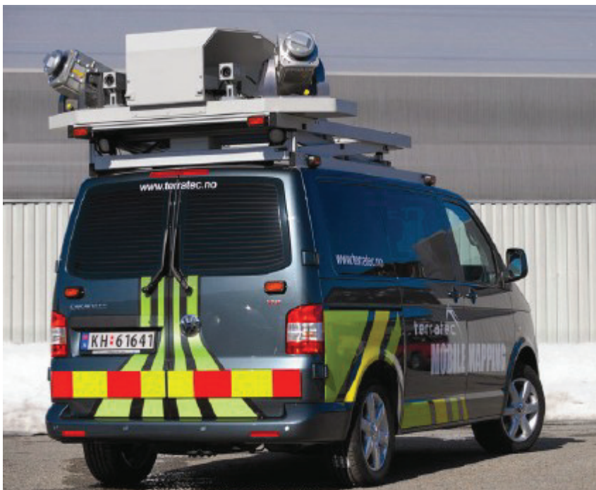
Illustrasjon 2: Foto av hvordan en Lynx Mobile Mapper ser ut. På dette bildet er GNSS antennen tildekt. Bildet er hentet fra (Terratec 2009)
