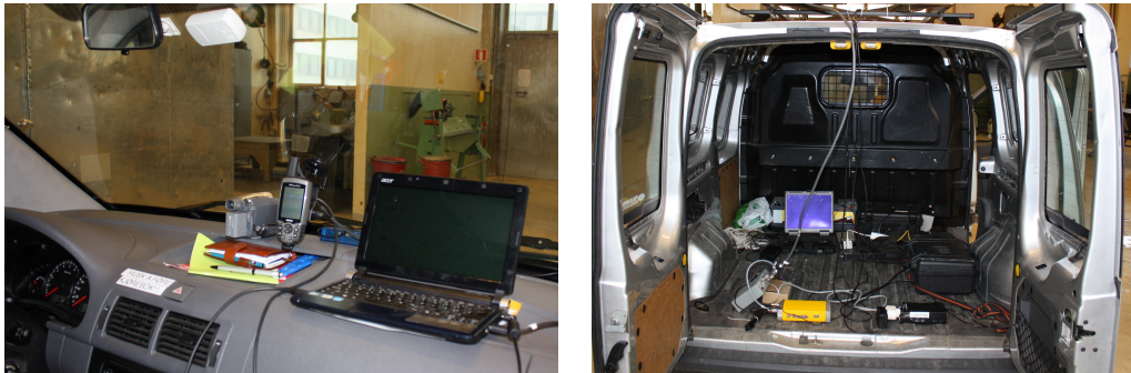
(a) Frontrute med videokamera, Garmin mottaker, OBU, og datamaskin for logging fra enhetene. (b) Lasterom med mottakerutstyr for antenner og HG9900 IMU.
