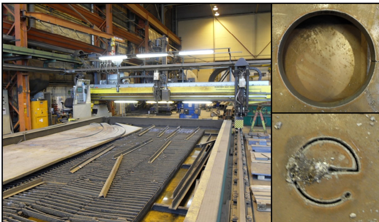
Figur 9-2 – Bilder tatt hos Rainpower. Til venstre vises skjærbordet. Øverst til høyre vises et eksempel på et sirkulært kutt med diameter på omtrent 200 mm. Nederst til høyre vises eksempel på et mindre sirkulært kutt på omtrent 80 mm.
