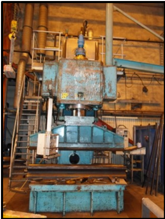
Figur 9-3 – Bilde av kantknekka tatt hos Rainpower. Designet for knekking av meget tykke plateformater.
