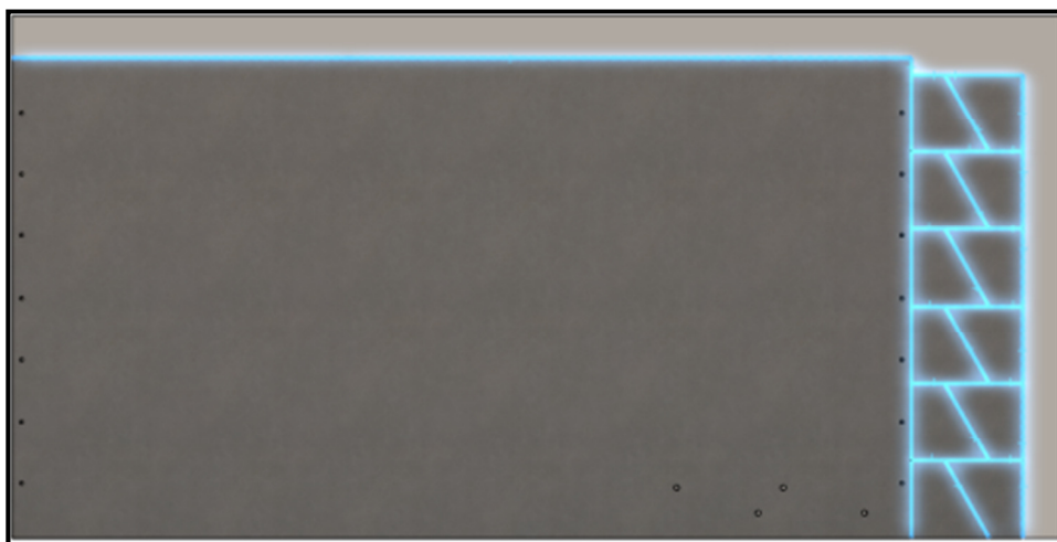
Figur 9-6 – Eksempel på beregning av skjærlengde. De blå linjene representerer kuttet fra plasmaskjæreren.
