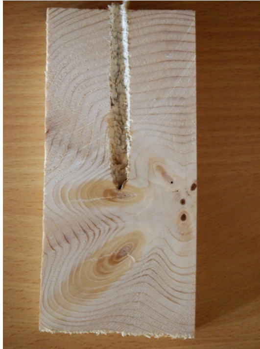
Figur 21: Kvist og medfølgende endring av fiberretning ga skruer 8 ekstra kapasitet
