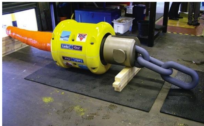
Figur 62 - Kobling til kjetting (Lankhorst Ropes, 2011).
