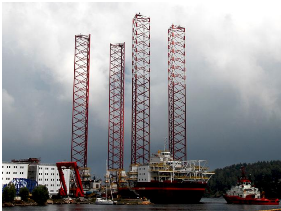
Figur 22 - Jack-up fartøyet L205 har en arbeidsdybde på opptil 130 m (Aalandslid, 2011).
