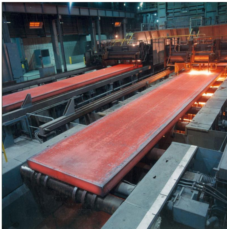
Figur 91 - Denne CNC gasskjæreren kan kutte 100 mm tykke plater, en større modell vil være nødvendig til skjæring av bjelke (Stahl, 2010).
