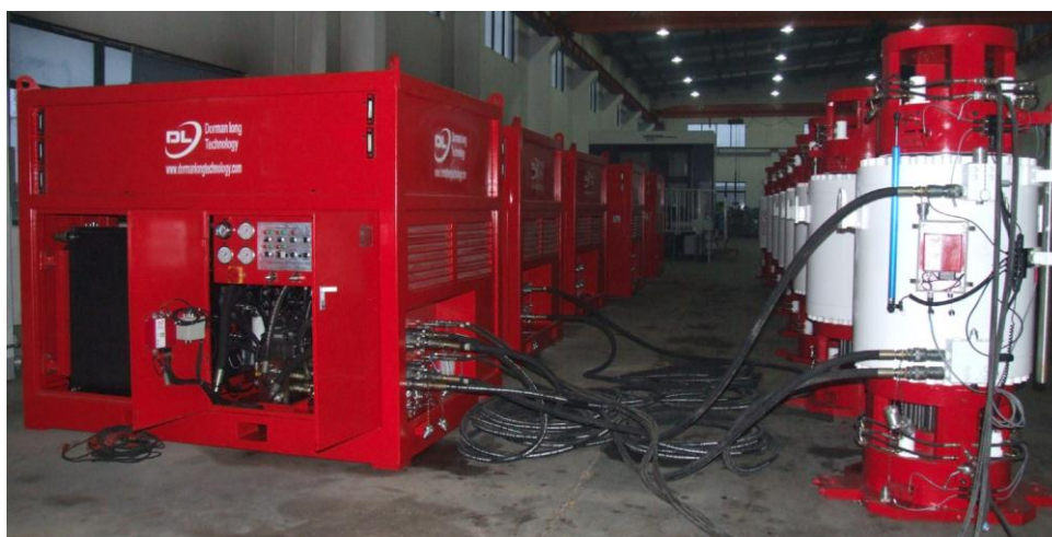
Figur 60 - DLT hydraulikk aggregat under testing av jekker (Dorman Long Technology, 2011).
