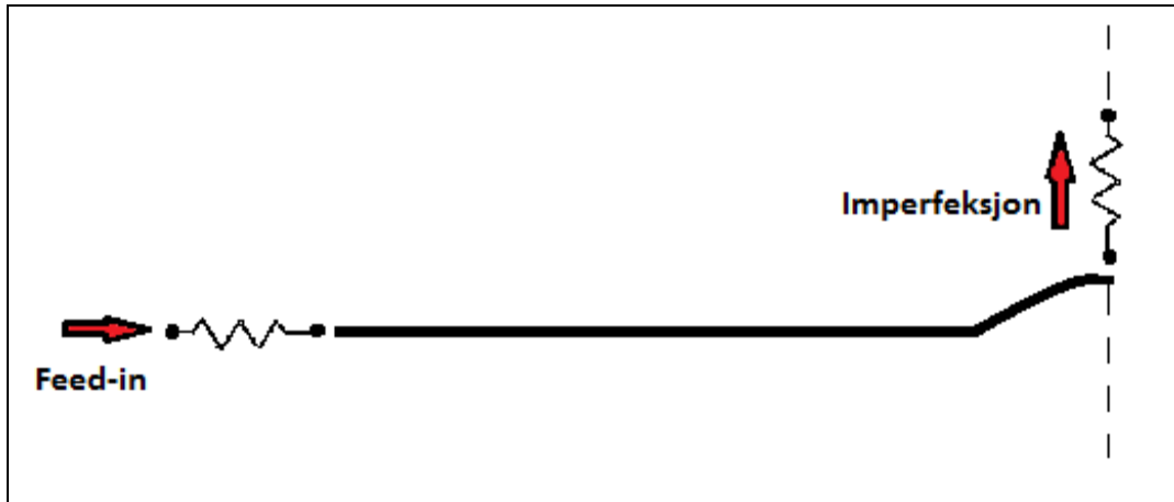
Figur 3.3. Modulering av rørledningen på havbunn med feed-in og imperfeksjon.
