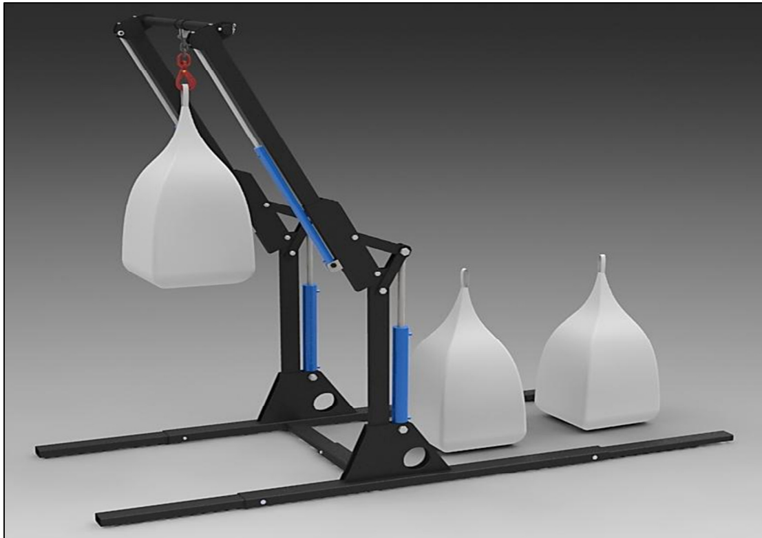
Figur 102: Storsekk løftet til posisjon der redskap kan plasseres under og sekken kan sprettes slik at emnet renner i beholder på redskap. Flere storsekker kan plasseres innenfor rekkevidden til kranen, dette gjør det raskt å fylle redskap.
