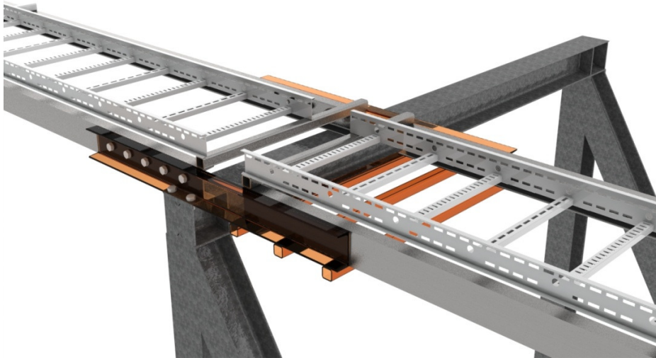
Figur 69 – Løsning med hensyn til termisk ekspansjon.
