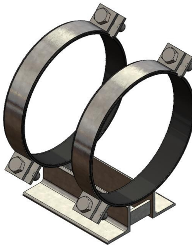
Figur 60 – Isolering mellom syrefaste rør og galvaniserte rørklammere.
