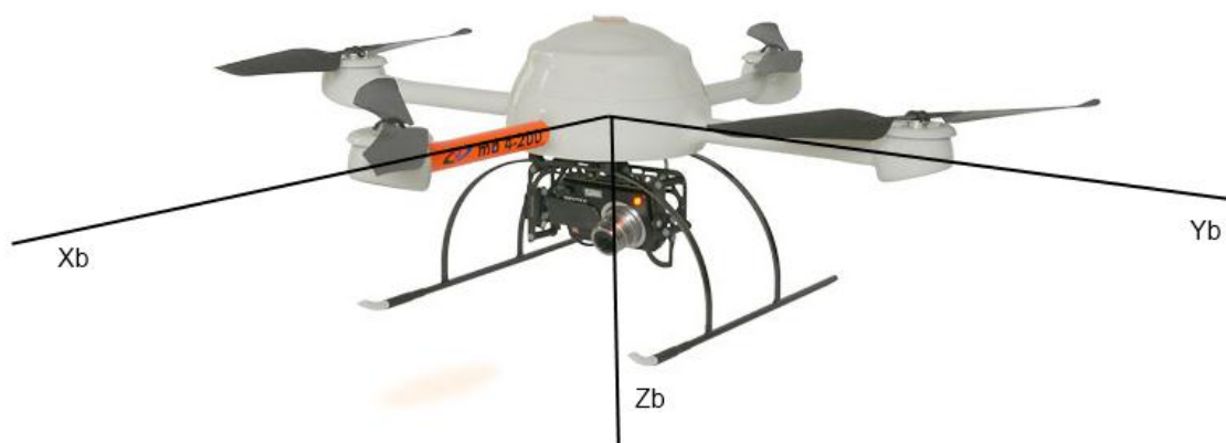
Figur 11: Body Frame tegnet på AeroVision sin drone MD4-200.
