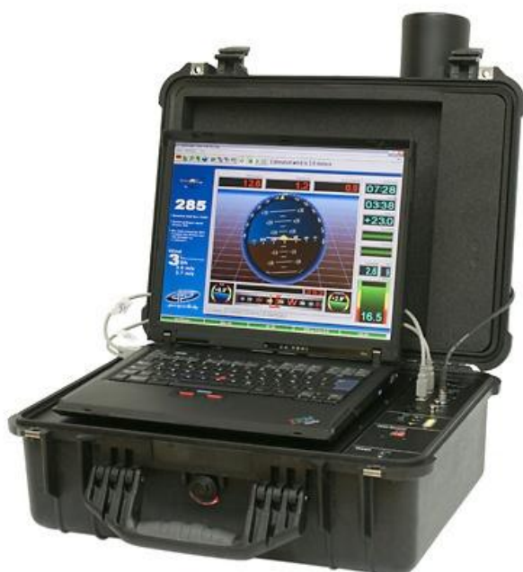
Bilde 3: AeroVision sin MD4 – 200 bakkestasjon. Foto: www.microdrones.com .
