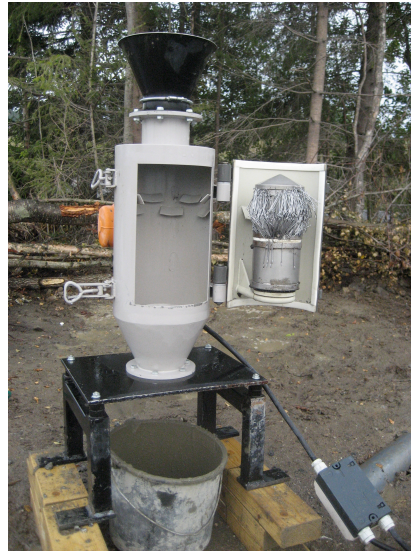
Figure 17: Magneten på døren samler opp all fiberen.
