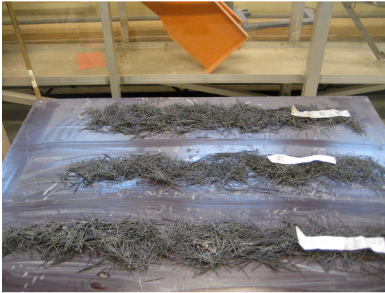
Figure 20: Fibrene tørkes for de veies.
