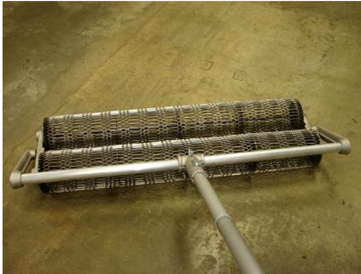
Figure 8: Fiberrulle minsker faren for fiberoppstikk. (18)
