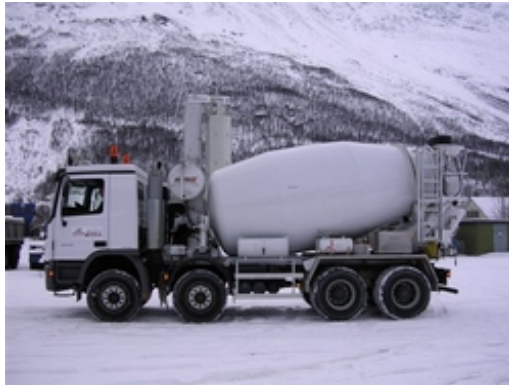
Figure 25: Betongbil med trommel hellende mot førerhytta. (43)
