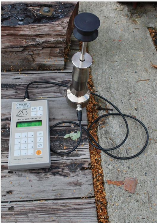
Bilde 8 - Motstandsmåleren i bruk
