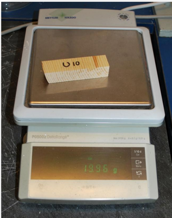
Bilde 10 - Veieing av uimpregnerte prøver
