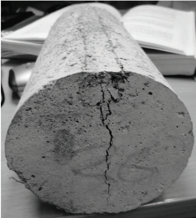
Figur 29: Tydelig trykkbrudd i overkant av sylinder nr. 26 (Fredrik Moen Haaland, 2010)
