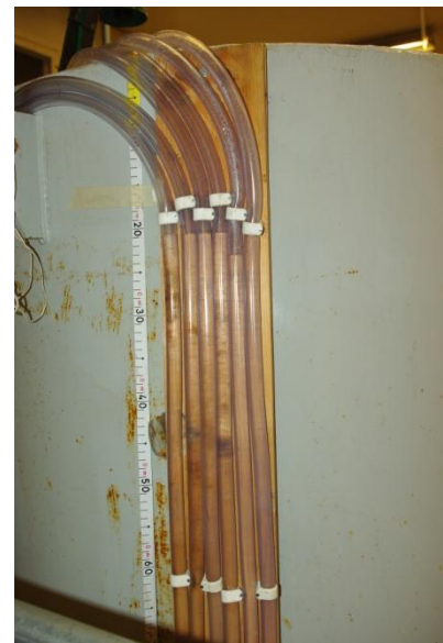
Bilde 1: Stigerør for trykkavlesning
