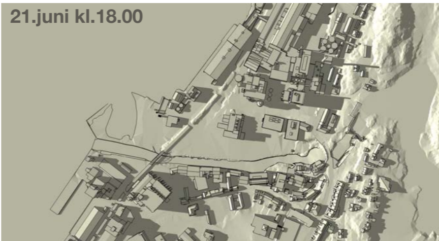
Fig.2.16: Sol- og skyggediagrammer generert fra 3D-modell i SketchUp.
