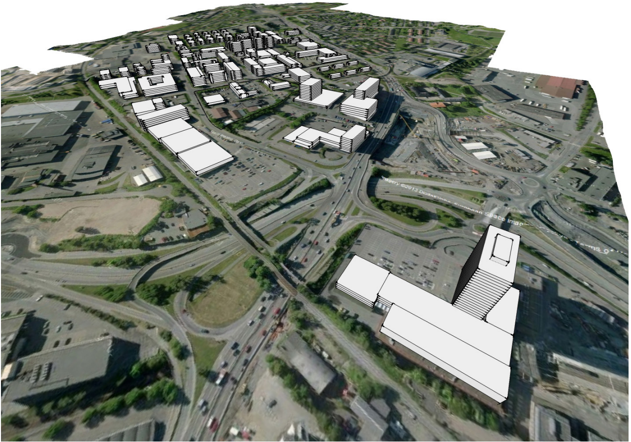
Figur 17: Skjerm bilde fra SketchUp som viser eksisterende bygninger på Løren som ble modellert. Økernsenteret nederst i bildet ble hentet inn gjennom Google 3D Warehouse og endret slik at det står plassert i terrenngmodellen.
