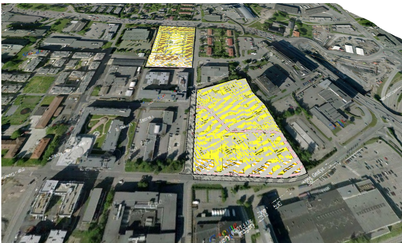
Figur 16: Skjermbilde fra SketchUp som viser et eksempel på hva som skjer hvis to forskjellige 3D-objekter deler samme tredimensjonale rom i modellen.
