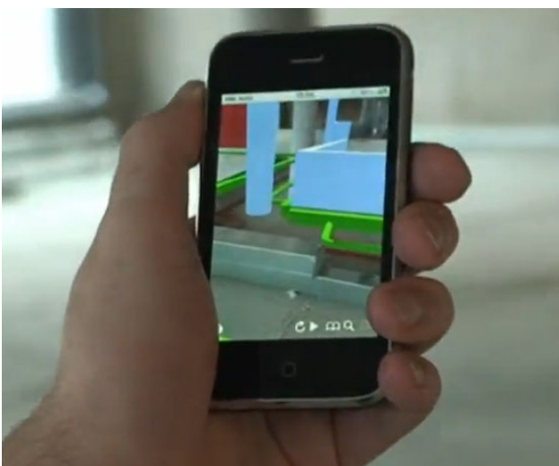
Bilde 2.3.4: Augmented reality: Her kan man se hvordan rørene skal ligge i et bygget (FormitasTV 2013).
