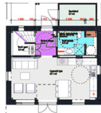
Fig 1.3. Shelter hustypen er utviklet som et fleksibelt byggesystem hvor Shelter 1 utgjør grunnmodellen, Shelter 2 og 3 utvidelser i hver sin retning, mens Shelter 4 er utvidelse i begge retninger. (Aktivhus)
