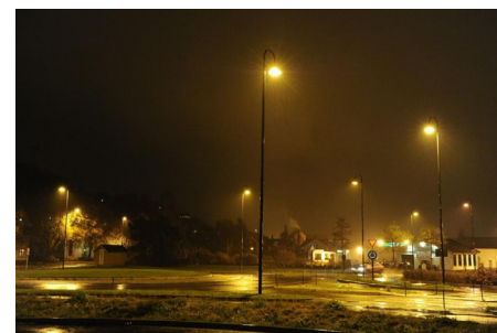
Figur nr. 33 Veg belyst med natrium lavtrykkdamplampe
