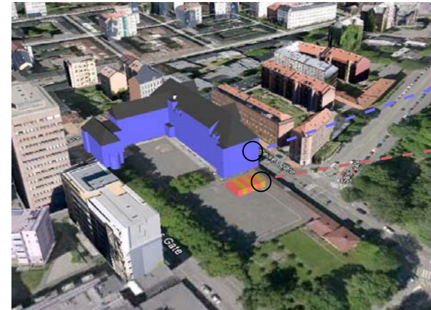
Figur 46 : Enkel riggplan presentert under oppstartsmøte på Herleb skole. Det er her brukt SketchUp og Google Earth for enkel visualisering av brakkeriggen. Det er her en stor fordel ved å ha prosjekteringsmøter på brakkeriggen i umiddelbar nærhet til prosjektområdet. Dette beskrives yttligere i kap 4.6
