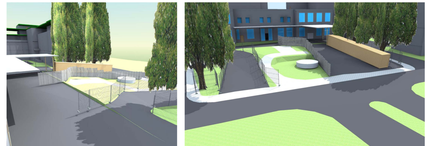
Figur 66 : Eksempel på riggplan presentert i 3D på Akutten ved Ullevål sykehus. De enkle illustrasjonene er laget av entreprenør på grunnlag av BIM-modell. Foto: HENT AS/ Jan- Øyvind Kirsebom
