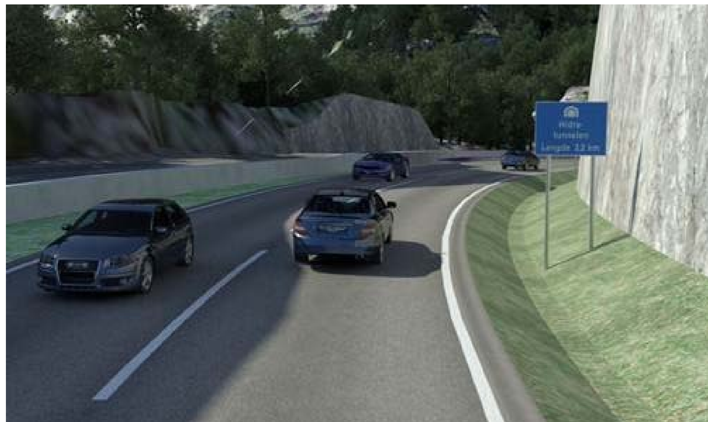
Figur 27 : Ved hjelp av prosjekteringsmodellen er det mulig å hente ut gode illustrasjoner langs den nye veistrekningen. I tillegg kan veien prøvekjøres på en digital sluttbefaring lenge før anlegget står ferdig. På den måten kan kjøreopplevelsen i landskapet oppleves og eventuelt revideres før entreprenøren starter å grave. Foto: SSV/Multiconsult
