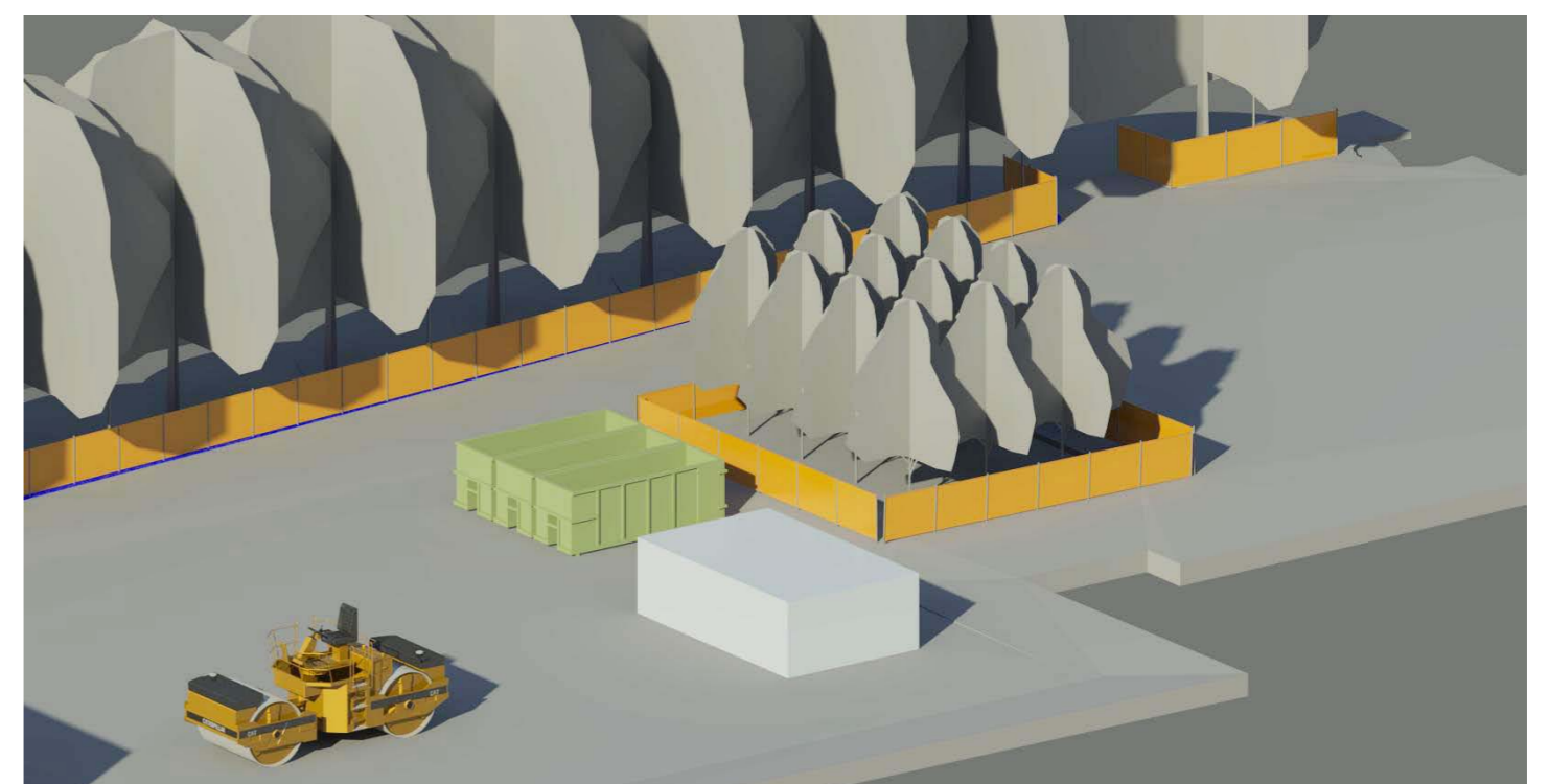
Figur 69 : Riggplan fra Hersleb i 3D
