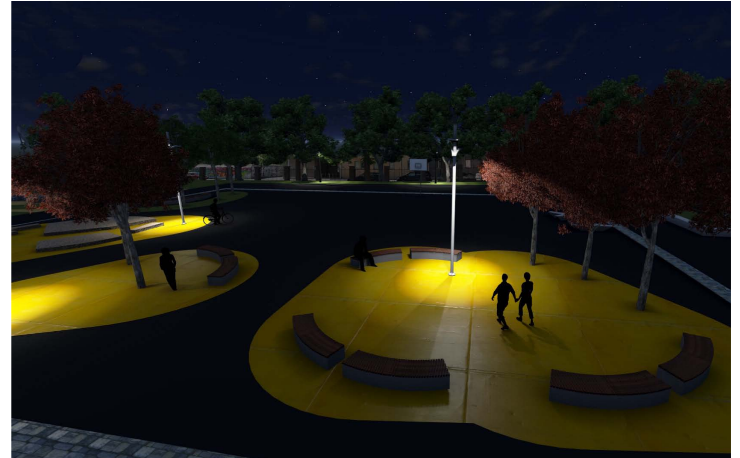
Figur 8 : 4D: Illustrasjon hentet fra programmet Lumion. I dette programmet er det mulig å styre været, f.eks slik at objekter beveger seg i takt med for eksempel vind. Lumion er kun et illustrasjonsverktøy, men BIM-modeller kan importeres for å lage animasjoner av anlegget. I denne illustrasjonen er det jobbet med belysning. Foto: Henning Jensen
