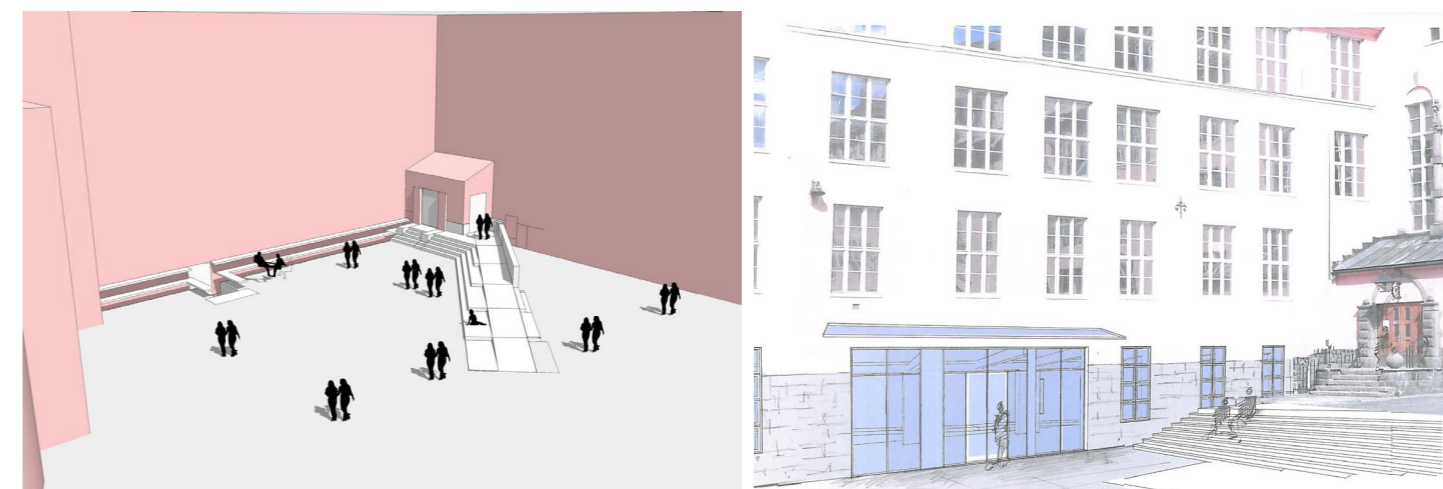
Figur 43 : Viser Tidlige skisser fra skissefasen av den nye hovedinngang til Hersleb skole. Bildet til venstre viser skisse fra Sketchup av rampe mot eksisterende hovedinngang. Bildet til høyre er illustrasjon av nytt inngangsparti der man graver seg ned til underetasjen. Illustrasjoner: ARCH UNO AS.
