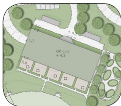
Grønne tak og plantebed for håndtering av overvann
