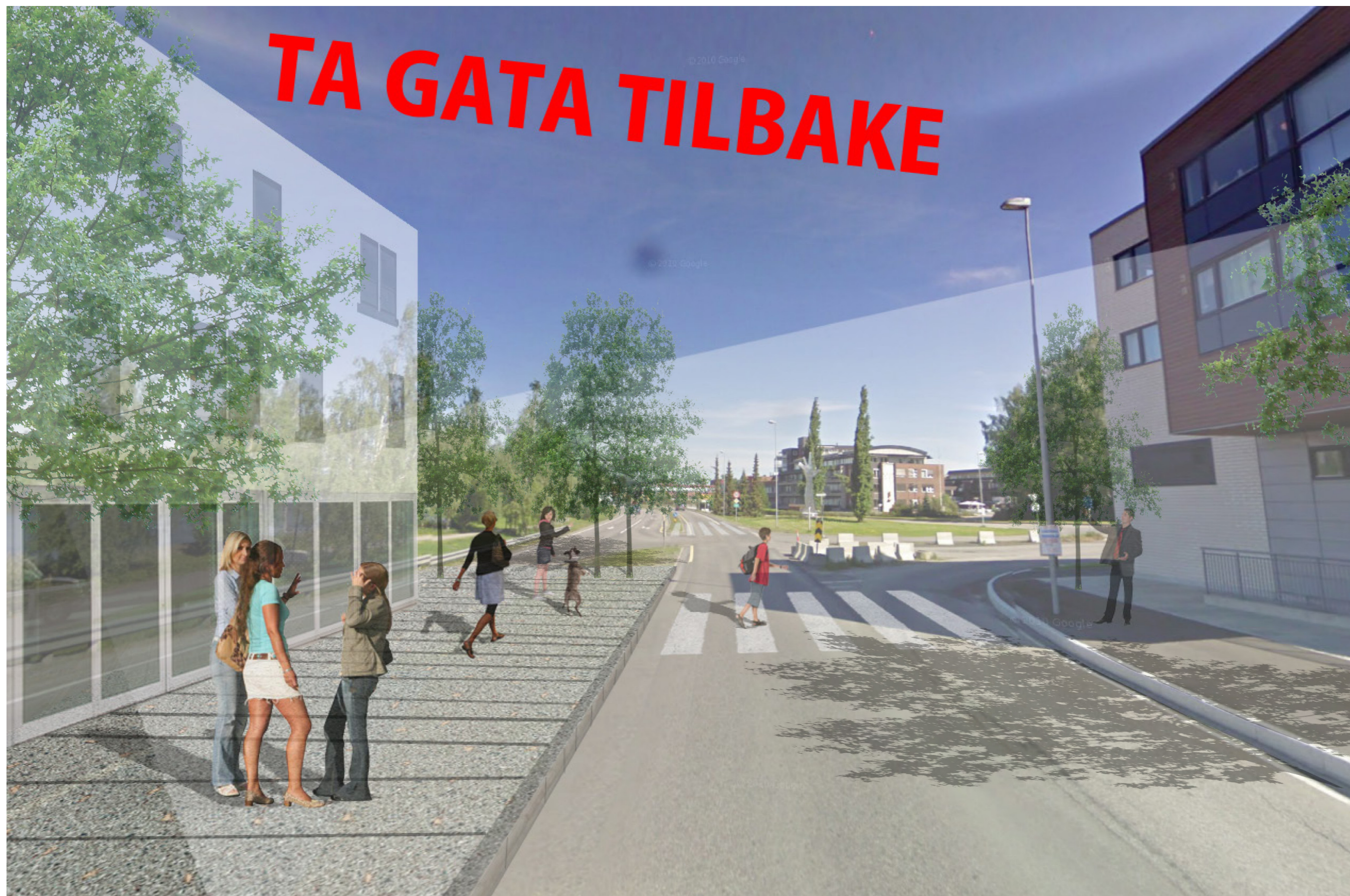
Figur 2.20. Ta gata tilbake! Plakat som illustrerer muligheten for å redusere veibredden langs elva og transformere til gate med fortgjengeroverganger i plan. Eksisterende vei er svært arealkrevende og bør strammes inn.
