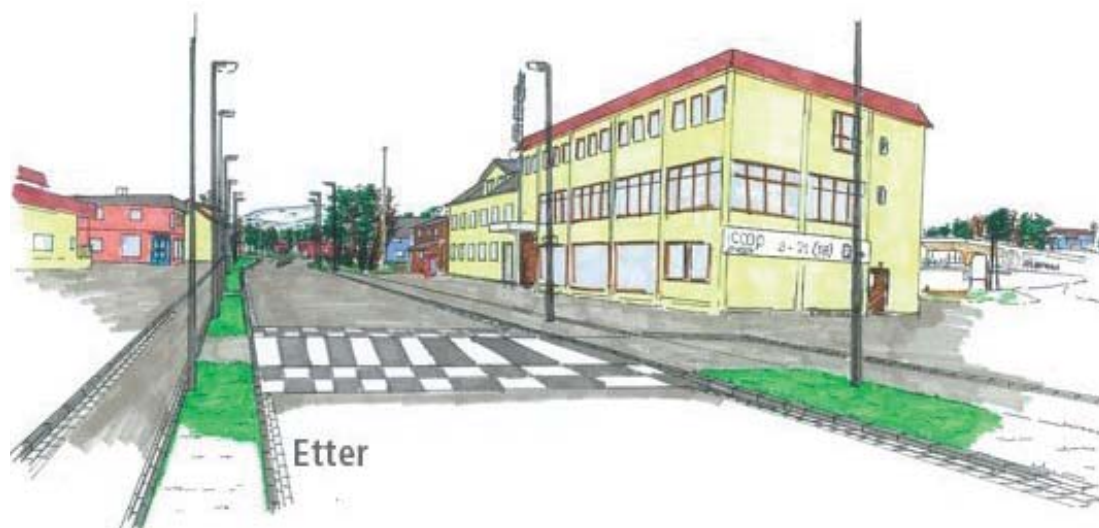
Fig. 4.22 Setermoen etter oppgraderingen. Anlegget har fått opphøyd gangfelt, ledelinjer og gress rabatter (Statens vegvesen 2009b).
