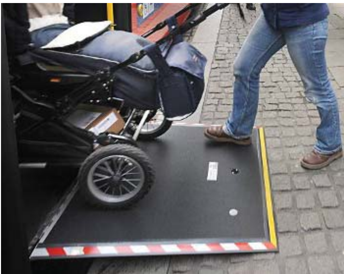
Fig. 3.14 Funksjonell rampe med landingsarealet som er bredt nok for av- og påstigning av rullestol og barnevogn (Ruud 2009).
