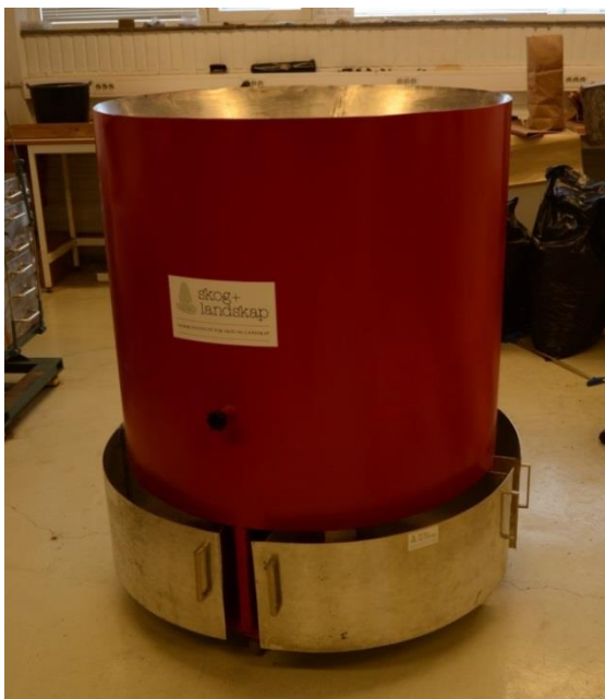
Figur 2.10: Apparat for akkumulering av underprøver til mekanisk sikting. Foto: Thor G. Lie.
