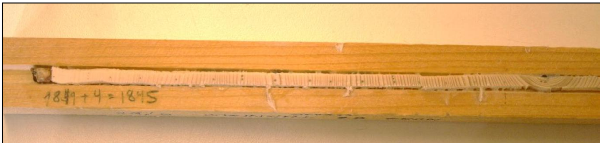
Figur 5: Ferdig oppmontert kjerneprøve, som er slipt, pussa og datert. Foto: Trønnes.
