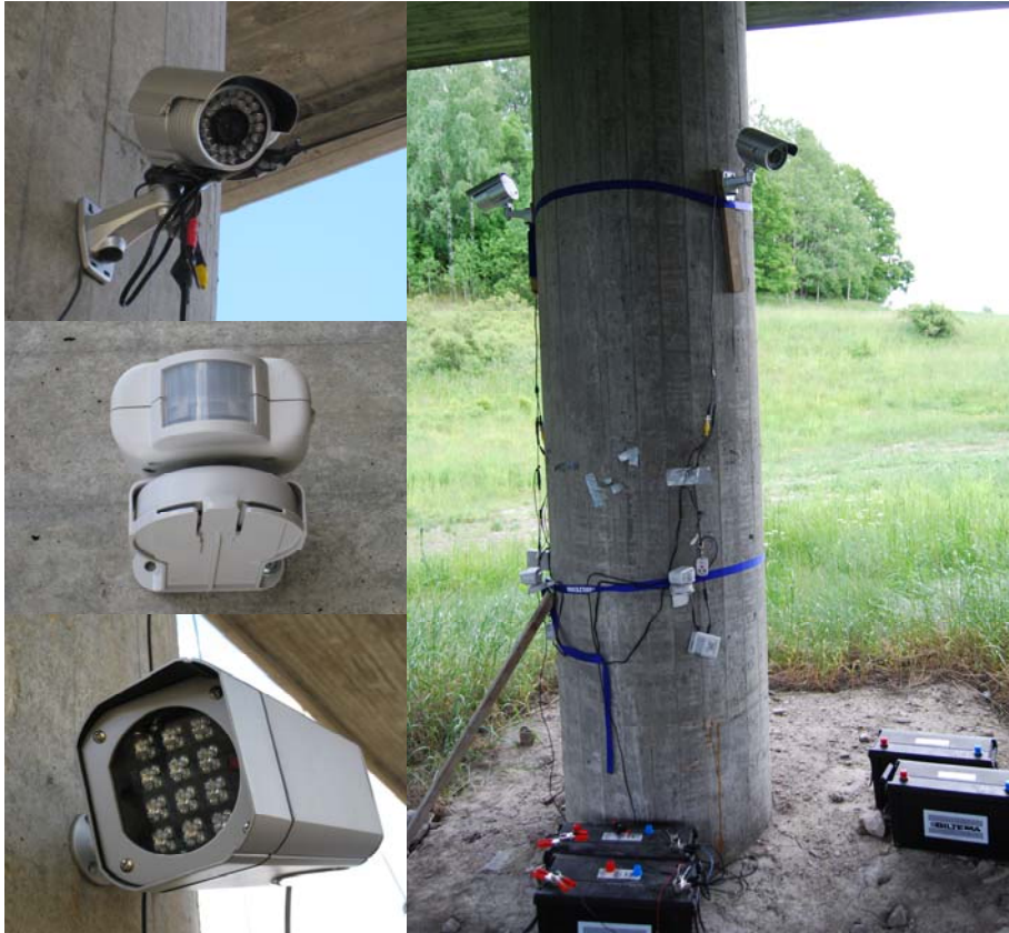
Figur 2. Kamera, sensorer og ekstra IR-lys var uavhengige deler som gjorde det mulig å plassere ut flere sensorer per kamera og per passasje. Delene sees nedover i bildet til venstre (kamera øverst, deretter sensor og ekstra IR-lys). Til høyre sees eksempel på et oppsett med to kameraer. Foto: R. Steen og J.T.Lyngved.
