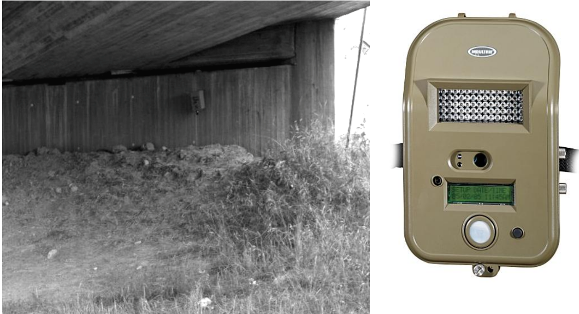
Figur 3. Til venstre er et eksempel på oppsett av fotokameraet. Her er sensorer, IR-lys, kamera og opptaksenhet samlet i en boks. Til høyre er et eksempel på en kameratype (Moultrie) som ble brukt i undersøkelsen. Foto: Winge våpen).
