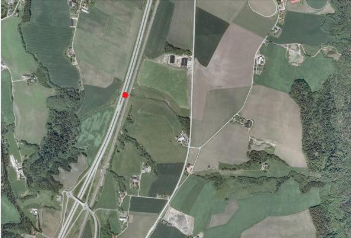
Figur 5. Klevjerhagen er en tilrettelagt viltpassasje i Sande i Vestfold. For å lede dyrene gjennom passasjene er det plantet korridorer på hver side av veien som skaper forbindelse mellom skogene på øst- og vestsiden av E18/jernbanen. Passasjen er markert med rødt i kartet. Bildet er fra 2007. Kilde: (Norge i bilder 2010).
