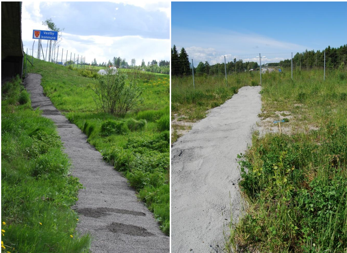
Figur 3. Eksempel på sandstriper for sporregistrering i undergangen på Støkken (til venstre) og på overgangen i Råde (til høyre) (Foto: Jo Trygve Lyngved).
