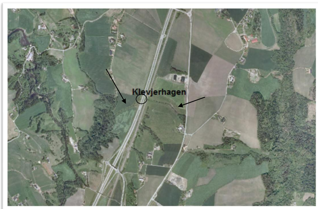
Figur 15. Flybilde over undergangen Klevjerhagen tilrettelagt for hjortevilt ved hjelp av en plantet vegetasjonskorridor som skal binde sammen skogholt på hver sin side av E18 og jernbanen. Korridoren er avmerket med piler på hver side av undergangen representert ved sort sirkelen (Foto: Norge i Bilder).
