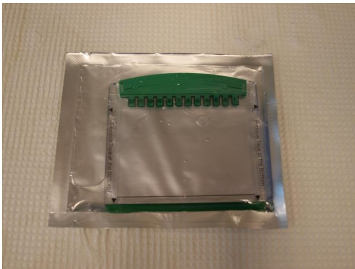
Figur N: Gel til SDS-PAGE
