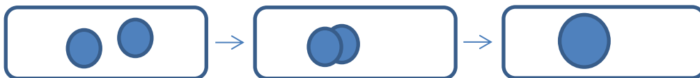
Figur 2.8. Hvordan to mindre bobler smelter sammen til en større boble (L. Pedersen, 2013).
