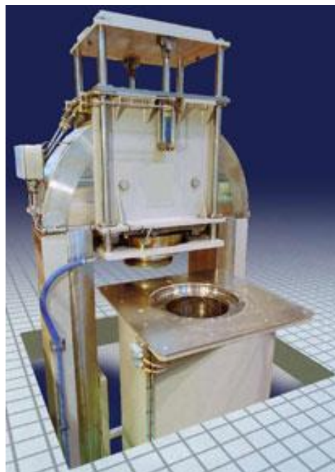
Figur 2.4. Høytrykksanlegg med 215 liters kapasitet og makstrykk 600 MPa (Avure, u.å.-a)
