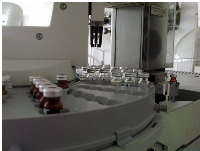
Figur 3.5: Gasskromatografen med injektoren og alle prøvene i en prøvekarusell (Foto Gunvor Ruud).
