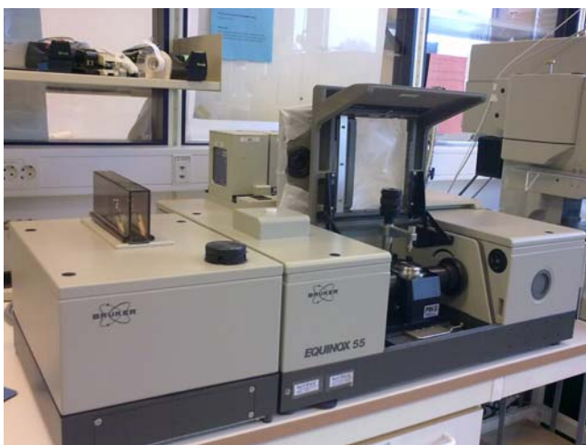
Figur 3.4: Til venstre vises FT-IR spektroskopet. Til høyre vises ATR-krystallen dekket med havremel (Foto Gunvor Ruud).
