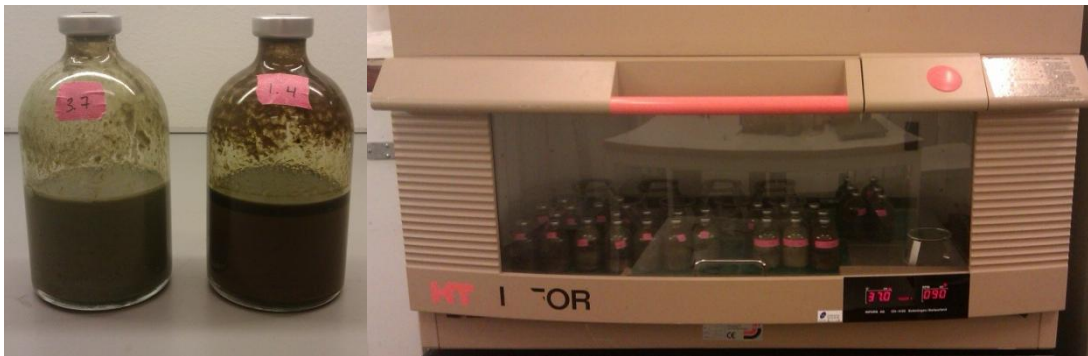
Figur 2. 2. Serumsflasker ble benyttet som batchreaktorer. Til venstre; 120 ml serumsflasker med 60 ml reaktormateriale. Til høyre; batchreaktorene ble inkubert i varmeskap (37 °C) med moderat risting. Foto: Live Heldal Hagen.
