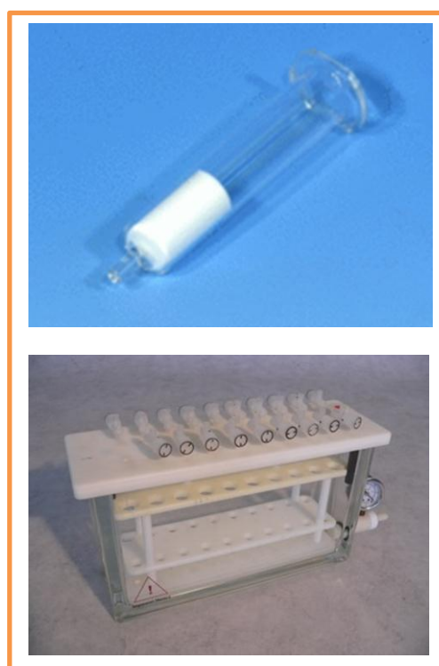
Figur 8: SPE-kolonne og "vacuum manifold". Det øverste bildet viser en glasskolonne som ble brukt i oppgaven. Disse ble plassert på et "vacuum manifold" som vises nederst i figuren. (Gemini BV Laboratory 2012; Macherey-Nagel 2012)
