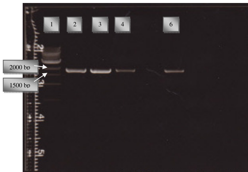
Figur 4.6: Test av transformasjon; W99A-AMCase i P. pastoris . PCR-produktet skal bli 1929 bp stort. Brønn 1: 1 kb ladder; brønn 2, 3, 4 og 6: W99A i P. pastoris .
