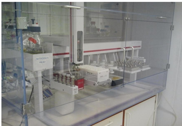
Figur 1.15: Instrumentet Gerstel MultiPurpose Sampler MPS 2XL Twister – automatisert fast fase ekstraksjon (eget bilde)
