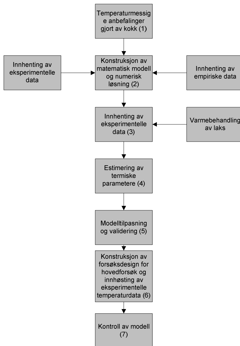
Figur 3: Skjematisert oppsett som illustrerer resolutiv tilnærming med hensyn på å konstruere analytisk modell for varmegjennomgang i SALMA-laks.
