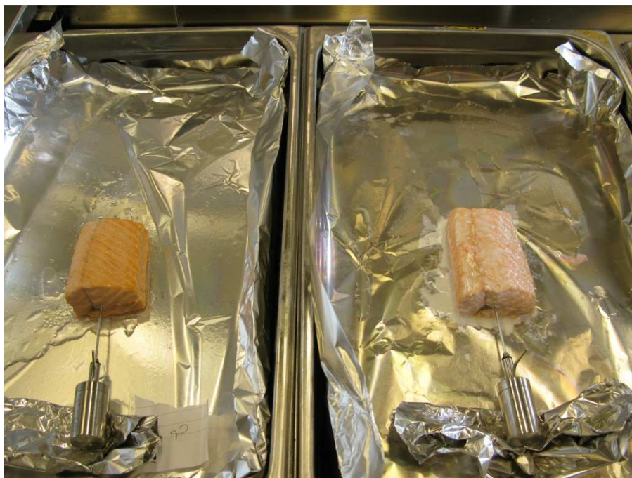
Figur 6: Laks varmebehandlet ved henholdsvis 95°C i 9 minutter (t.v.) og ved 65 °C i 19 minutter etter endt hviletid. Plassering av temperaturloggere og opplegg på stekebrett med aluminiumsfolie som vist i figuren er representativ for alle prøvene i forsøket.
