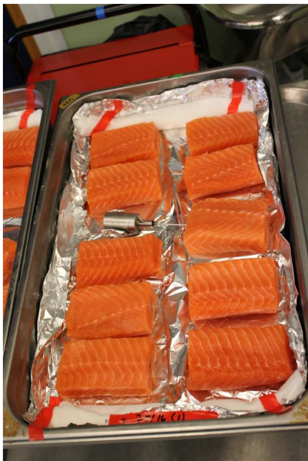
Figur 8: Fordeling av prøver på brett før varmebehandling. Prøve nummer tre fra bunnen til høyre var kontrollstykket. Bildet viser hvite kluter som ble plassert langs kortsider med hensikt å samle opp væske avgitt fra prøver.
