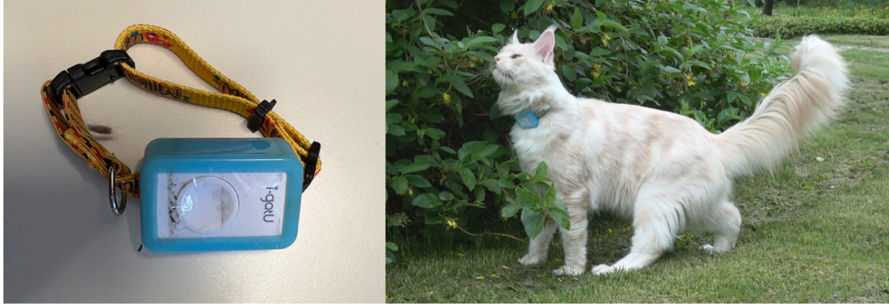
Figur 3: Venstre: GPS-enhet type i-gotU GT120 som ble brukt på kattene i prosjektet for å registrere posisjoner. Høyre: GPS-halsbåndet festet på en katt fra et tidligere år.
