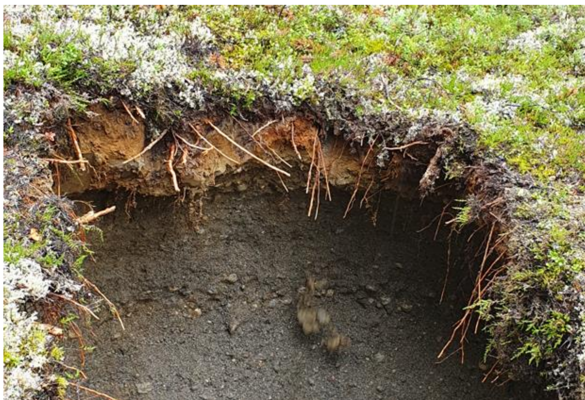
Figur 5-2: Rustbrunt sjikt i jordprofilet. Høyt jerninnhold. (Foto: Privat)
