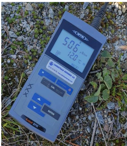
Figur 5-9: Måleinstrument for måling av ledningsevne. (Foto: Privat)
