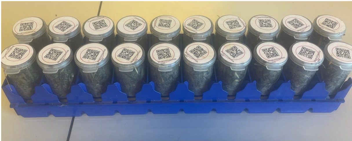
Figur 8: Skinne med 20 Olabeger fylt med grovfôr. Påsatt QR-kode for skanning av NIRS instrumentet
