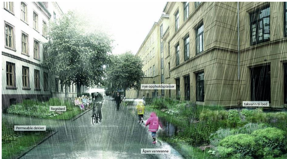
Figur 4. Oslo kommunes pilotprosjekt for lokal overvannshåndtering i Deichmanns gate. Fremstillingen inneholder naturbaserte løsninger som permeable dekker, regnbed og åpen vannrenne. Illustrasjon: Bymiljøetaten. Hentet fra Røed (2019).
