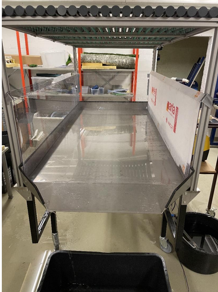
Figur 15: Plastikk-veggene montert på siden av grunnflaten under regntaket.
