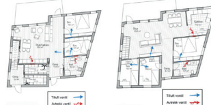
Figur 52: plan 1.etg og 2. etg, bolighus vest som viser plassering på tillufts- og avtrekksventiler
