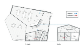
Figur 53: Plan 1.etg og Kjeller Felleshuset som viser teknisk rom og plassering av tillufts- og avtrekksventiler
