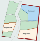
Figur 32: Funksjonene på tomte. Rødt firkantet strek representerer "muthuden" som diskuteres under 5.4 Bolighus
