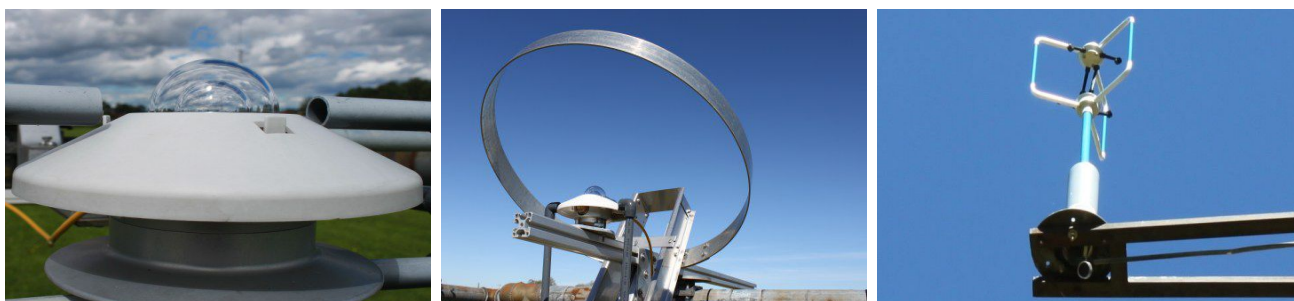
Figur 3.3: Måleinstrumenter brukt til å innhente værdata på Søråsjordet. Til venstre og i midten vises Kipp & Zonen CMA 11 pyranometrene som brukes ved værstasjonen på Søråsjordet. I midten også med skyggering for å måle diffus stråling. Til høyre vises Gill Instruments Windmaster ultralydanemometer i bruk på Søråsjordet. Bildene er hentet fra BIOKLIM (2014a, for pyranometrene) og BIOKLIM (2014c, for ultralydanemometeret).
