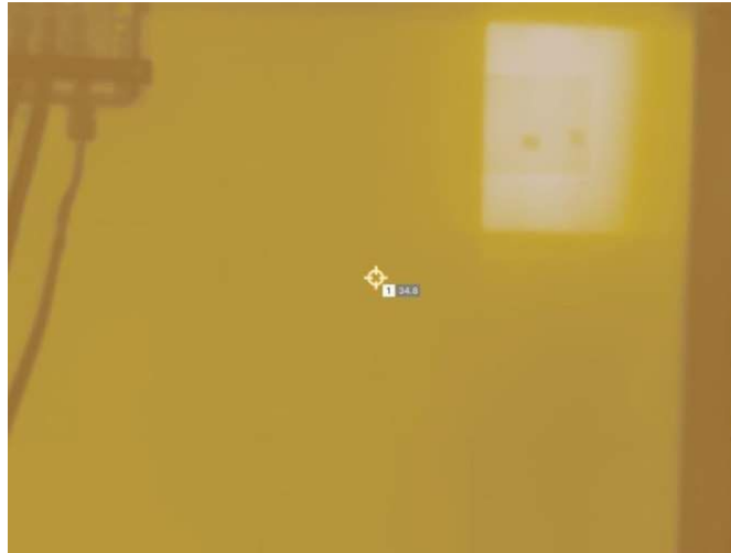
Figur 2.15: Termografisk bilde av en solcellemodul med en overopphetet celle. Den overopphetede cellen (hvit firkant øverst til høyre) har en temperatur på 80 °C, mens resten av modulen holder rundt 35 °C. Bildet ble tatt som en del av laboratorieøvelse 1 i faget FYS375 – Energiteknologi laboratorium ved NMBU.
