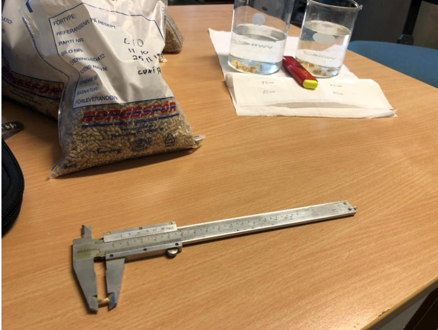
Figur 6 måling av pellett størrelse fra det første innsettet med skyvelære. Bilde tatt av Tony Penev.
