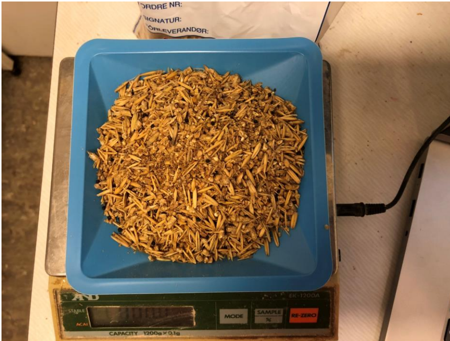
Figur 12 Mjølfôr prøve fra Kises andre innsett. 100 gram prøve brukt til tørrsiktingsanalyse. Bilde tatt av Tony Penev 8.3.2020.
