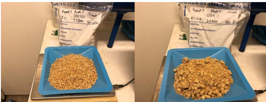
Figur 9 Mjølfør prøver fra Engesets første innsett. 100 gram prøver brukt til tørrsiktingsanalyse. Bilde tatt av Tony Penev 10.2.2020.
