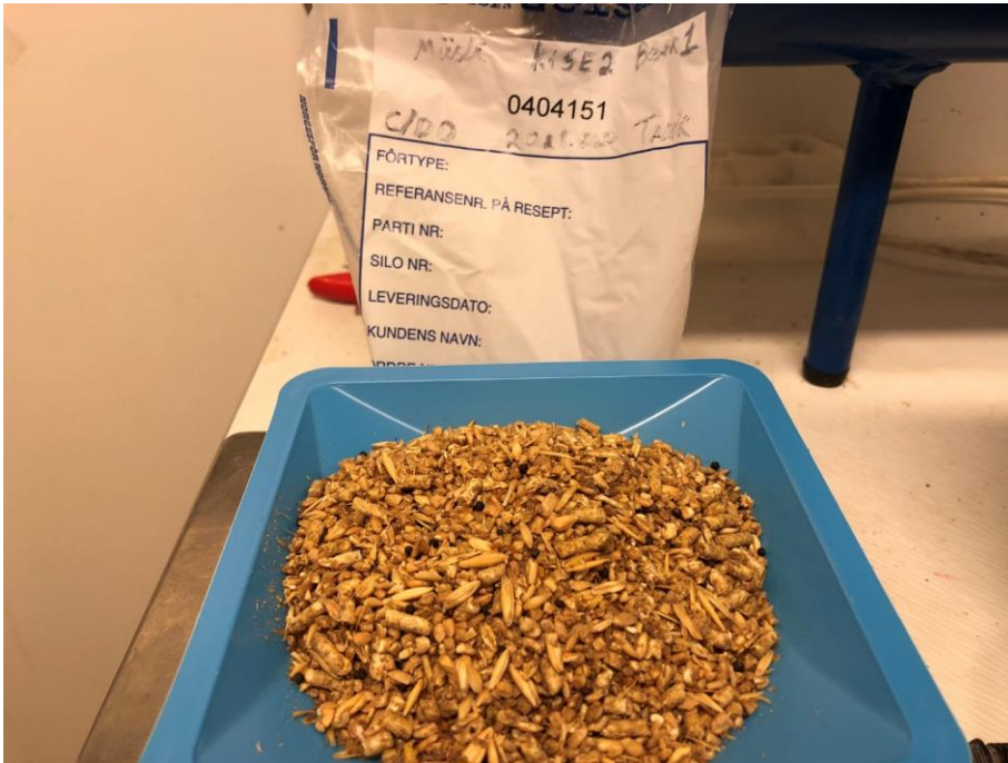
Figur 10 Mjølfôr prøve fra Kises andre innsett. 100 gram prøve brukt til tørrsiktingsanalyse. Bilde tatt av Tony Penev 8.3.2020.
