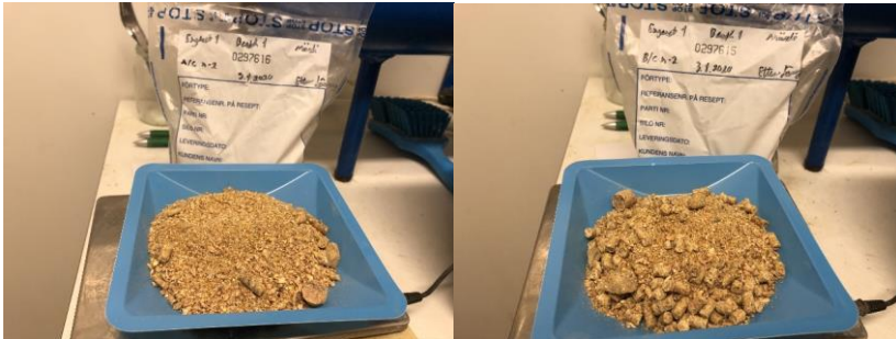
Figur 31 Stor forskjell i prøver fra Engesets første innsett, besøk 1, nest siste fôrsålers (figur x7) grove partikler kan muligens skyldes spor av større pellets i fôret. Den midtre fôrlinjen hadde langt flere av disse pelletene enn den første fôrlinjen.
