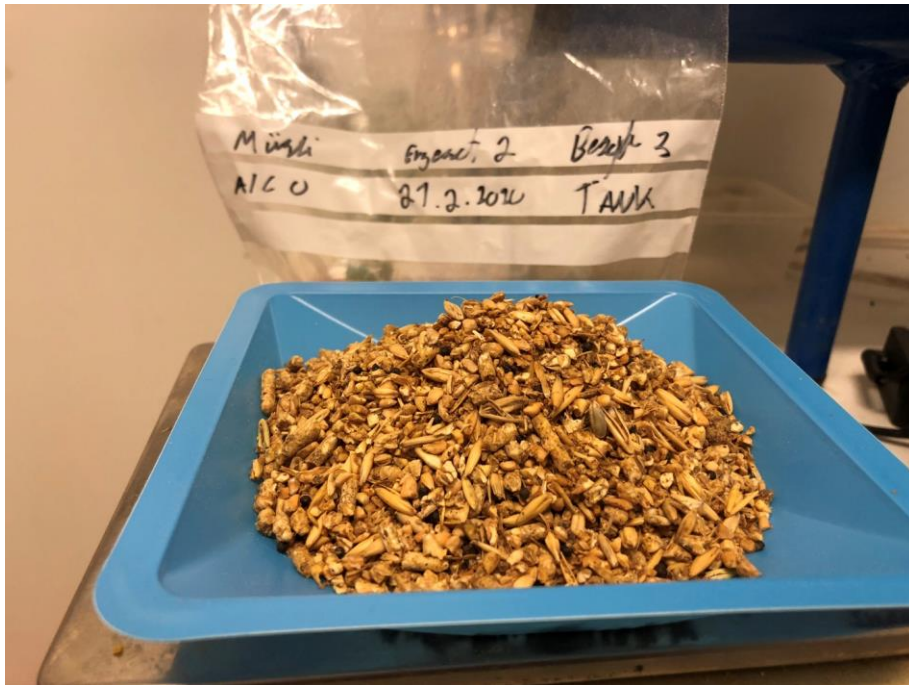
Figur 11 Mjølfôr prøve fra Engesets andre innsett. 100 gram prøve brukt til tørrsiktingsanalyse. Bilde tatt av Tony Penev 10.2.2020
