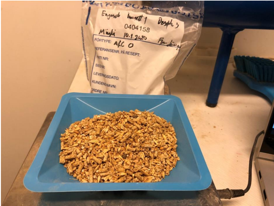
Figur 8 Mjølfør prøve fra Engesets første innsett. 100 gram prøve brukt til tørrsiktingsanalyse. Bilde tatt av Tony Penev 10.2.2020
