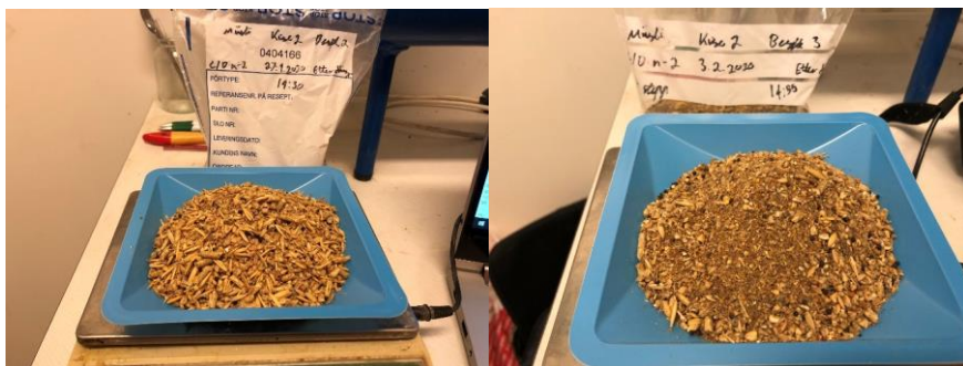
Figur 27 Mjølfôr prøver fra Kises andre innsett. 100 gram prøve brukt til tørrsiktingsanalyse. Venstre bilde er prøvemateriale hentet ved det andre besøket og tatt fra nest siste førskål på tredjefôrlinje etter en time med videopptak der kyllingene har hatt fri tilgang på fôret. Høyre bilde er fra samme skål, og omtrent samme tidspunkt tatt ved neste besøk når fôrstoppet var høynet fra to timer til tre timer. Bilde tatt av Tony Penev 8.3.2020.
