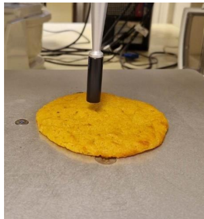
Figur 6: Bilde av kikertburger under TPA målt med en sylinder sonde.
